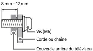
**3** Fixer le téléviseur au mur avec des boulons, un dispositif d'ancrage au mur et une chaîne (ou une corde).
